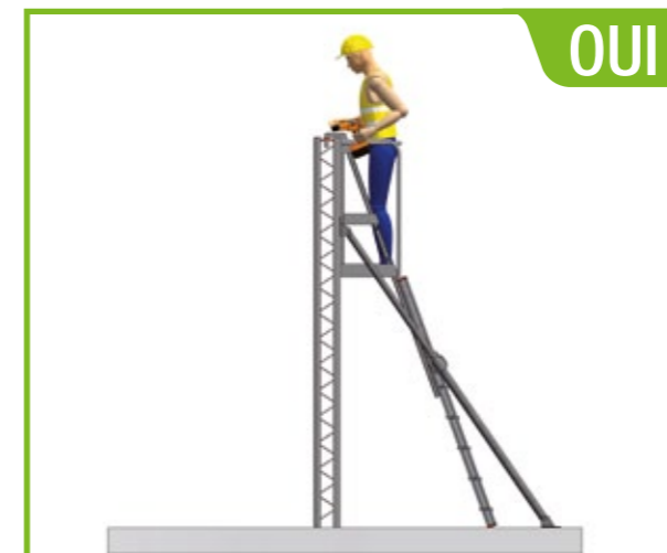
06 TRAVAILLER SUR DES POSTES SÉCURISÉS
