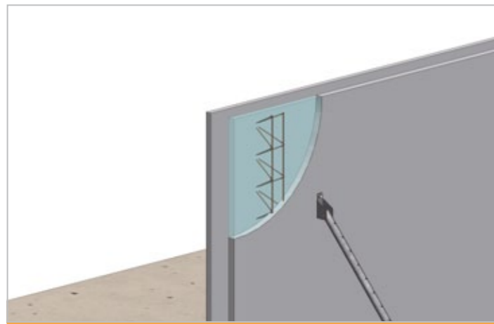
POSER LE 1 ER MUR
